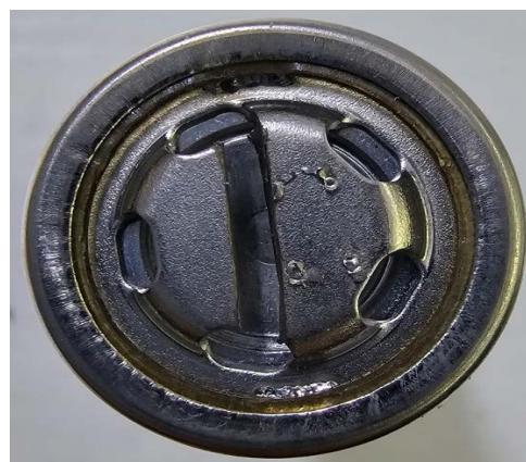
Рис. 2. Изображение положительного контакта батареи после обработки.
