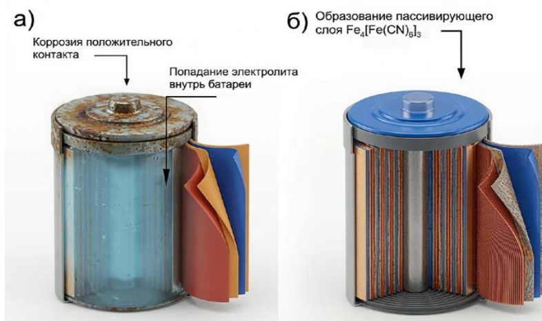
Рис. 7. Сравнительная схема процессов на положительном полюсе: а) сценарий коррозии контакта и нарушения герметичности; б) сценарий с образованием пассивирующего слоя берлинской лазури \text{Fe}_4[\text{Fe}(\text{CN})_6]_3 .
