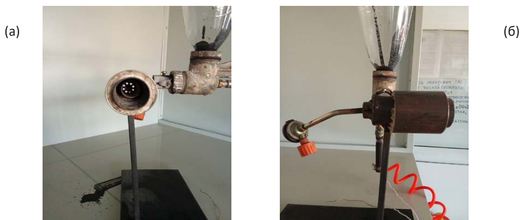
Рис. 2. Общий вид экспериментального стенда для горения водоугольной суспензии: (а) — фронтальный вид камеры сгорания; (б) — боковой вид установки с системой подачи топлива и воздуха.
