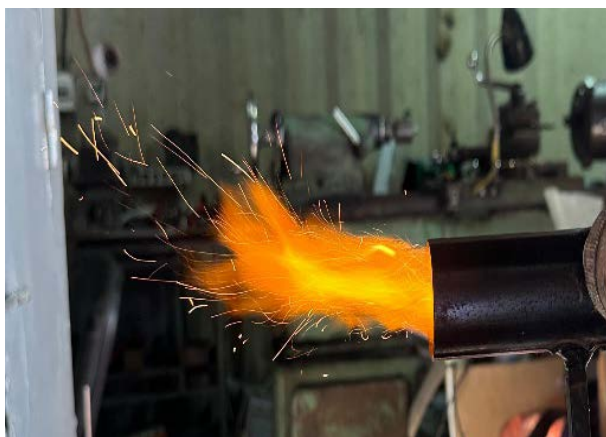
Рис. 3. Влияние состава водоугольной суспензии на характер горения и формирование факела при различных соотношениях угля и воды.
