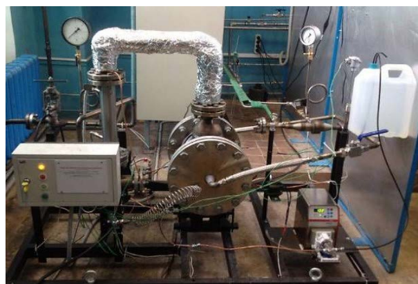
Рис. 2. Демонстрационный матричный риформер производительностью по входящему газу до 10 м 3 /ч.
