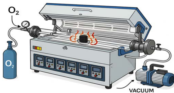
Сурет 3. Оттегі ( O_2 ) берілген кездегі вакуумды түтікше пештің жұмыс сызбасы.
