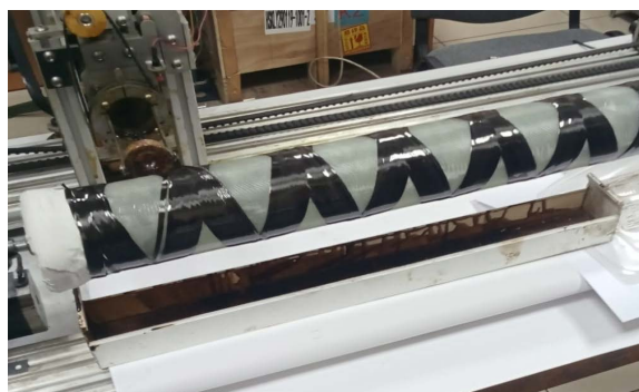
Рис. 1. Намотка углепластикового корпуса.
