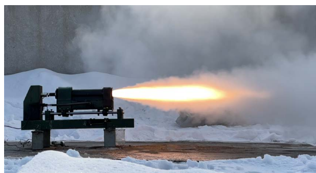
Рис. 5. Огневое испытание углепластикового корпуса.
