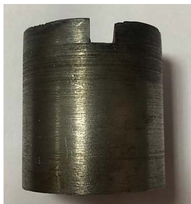
Рис. 1. Параметры вкладыша и внешний вид: а – размеры; б – внешний вид стального вкладыша.
