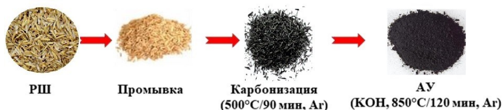
Рис. 1. Схема термохимического получения углеродных материалов из рисовой шелухи.
