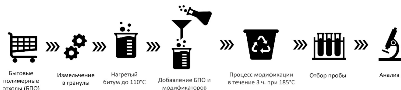
Рис. 1. Схема процесса модификации битумов полимерными отходами.
