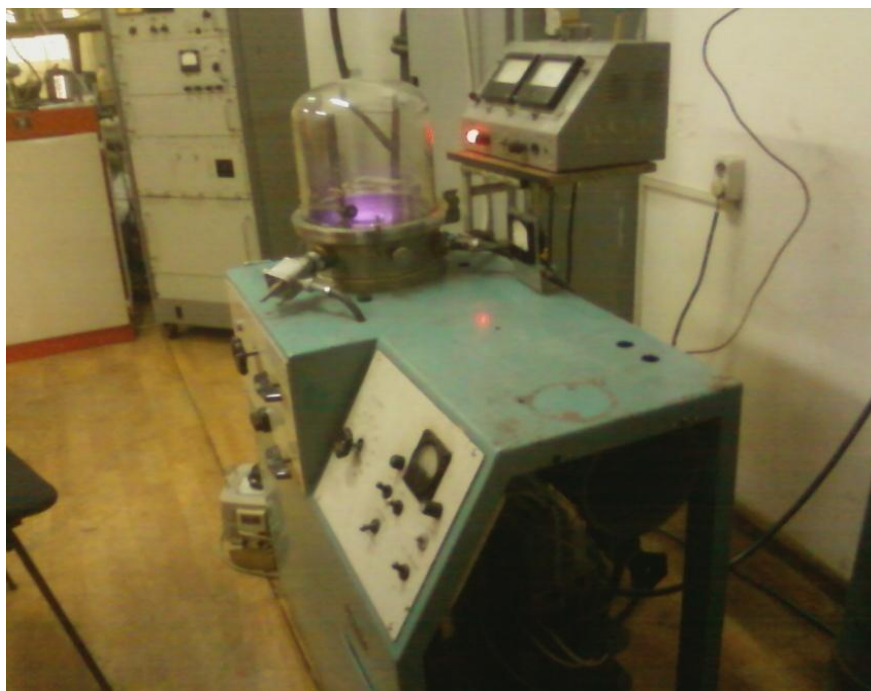
Рис. 1 – Общий вид модернизированной установки ВУП-2
