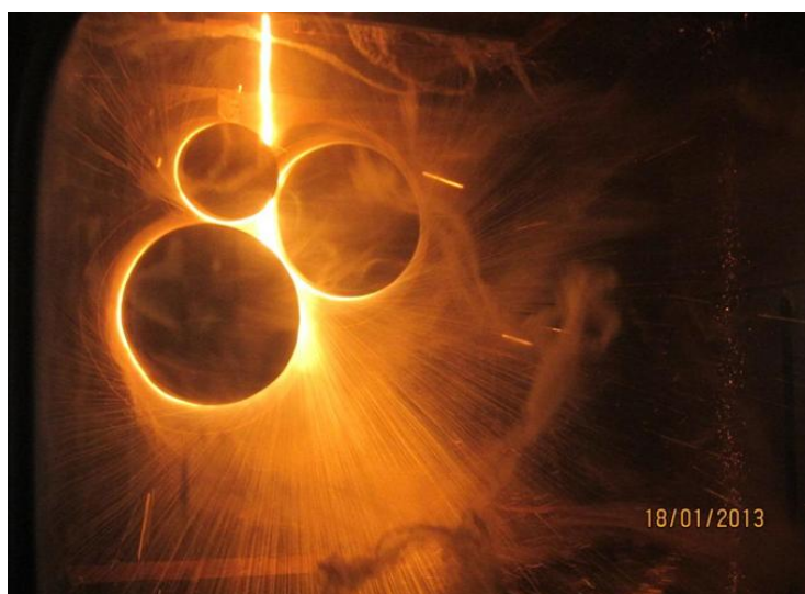
Рис. 6. Раздув струи базальтового расплава в волокно с помощью 3-х валковой центрифуги
