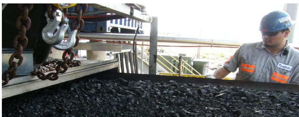
Рис. 19 – Высушенный уголь на выходе из СВЧ-сушилки
