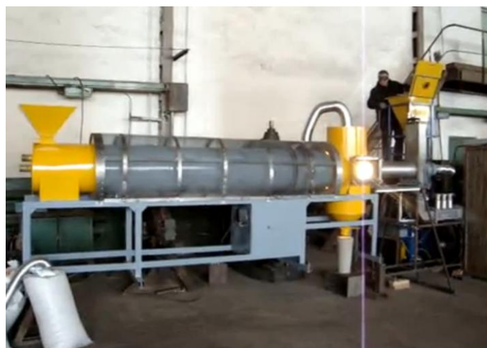
Рис. 8 – Станция СВЧ-плазменного сжигания угля (кадр видеofilьма)
