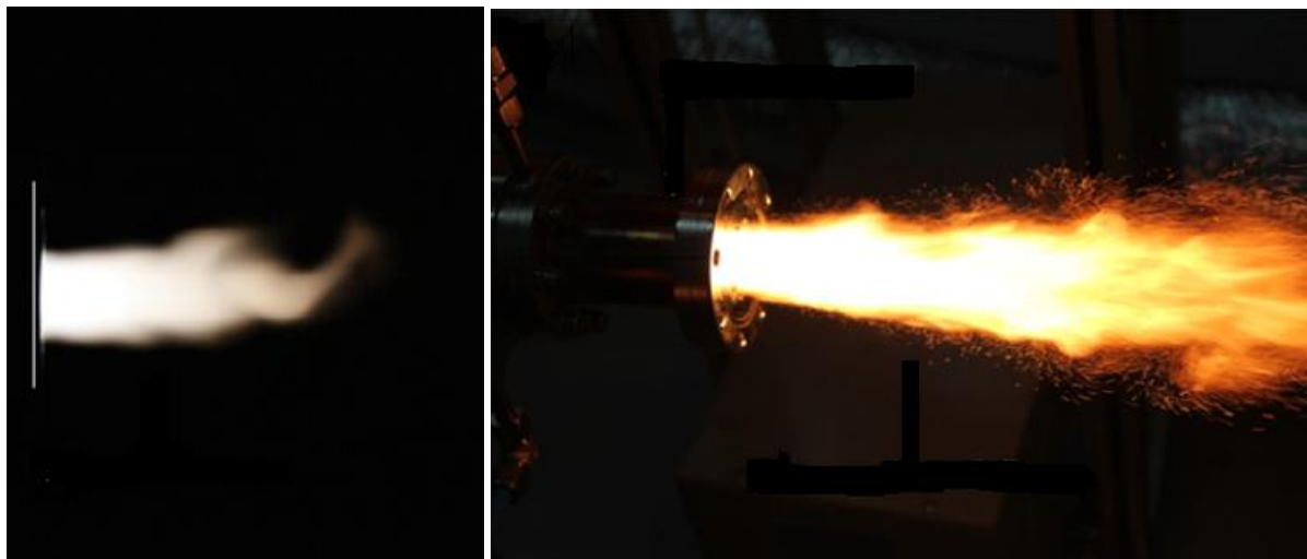
Рис. 10 – Слева: вспышка белого пламени (13 раз), справа: факел горения СВЧ-плазмы
