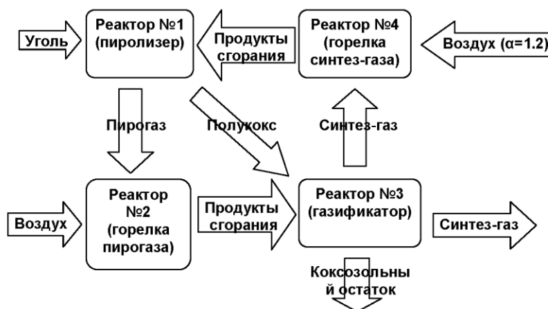
Рис. 1 – Схема процесса ступенчатой газификации угля (взято из работы [10])
