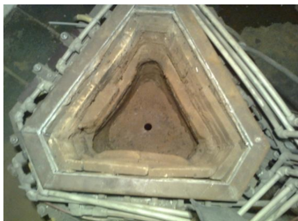
Рис. 8 – Плавильная камера после технологических плавки и отбор проб струи расплава
