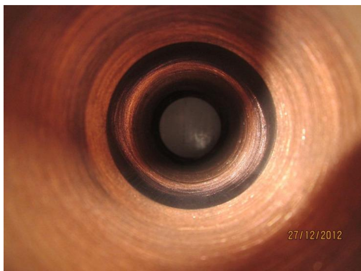
Рис. 6 – Внутренняя поверхность катода после 30 часов работы при токах до 500 А
