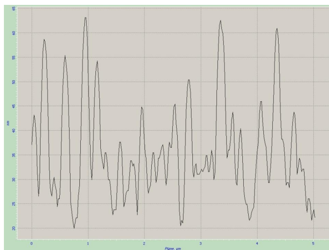
Рис. 11 – Профиль поверхности углеродной пленки на подложке нержавеющей стали, полученный с помощью атомно-силовой микроскопии
