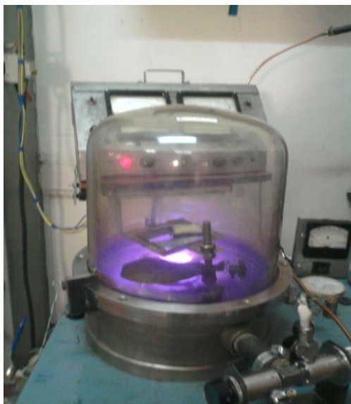
Рис. 1 – Рабочая камера модернизированного вакуумного универсального поста (ВУП-2) и магнетронный разряд в атмосфере ароматических углеводородов
