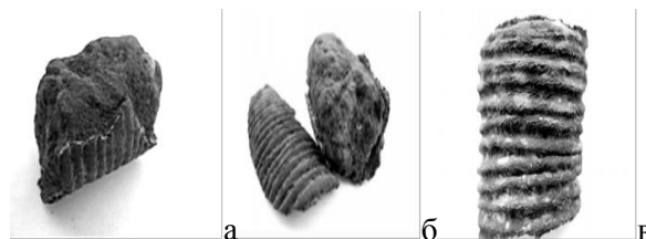
Рис. 5 – Фото макроструктуры образца с образованием пристеночной «корочки» (а, б) и структура самой «корочки» (в)
