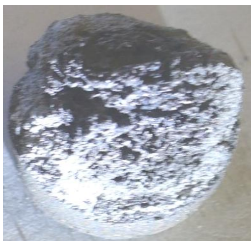
Рис. 4 – Внешний вид излома образца, синтезированного на основе шихтовой смеси (SiO_2+CaCO_3+CaSiO_3) , модифицированной янтарной кислотой и нашатырным спиртом
