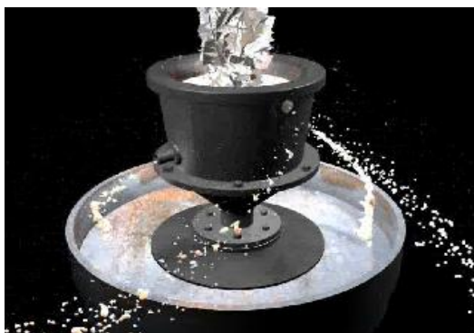
Рис. 4 – Фрагмент центробежного реактора для непрерывного восстановления, плавления и разделения металла и шлака
