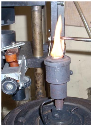
Рис. 1 – Фото пламени предварительно перемешанной пропан-кислород-аргонной смеси с помещенной в нее каталитической подложкой
