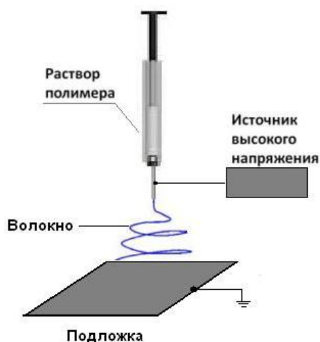
Рис. 1 – Схематическое изображение установки для электроспиннинга
