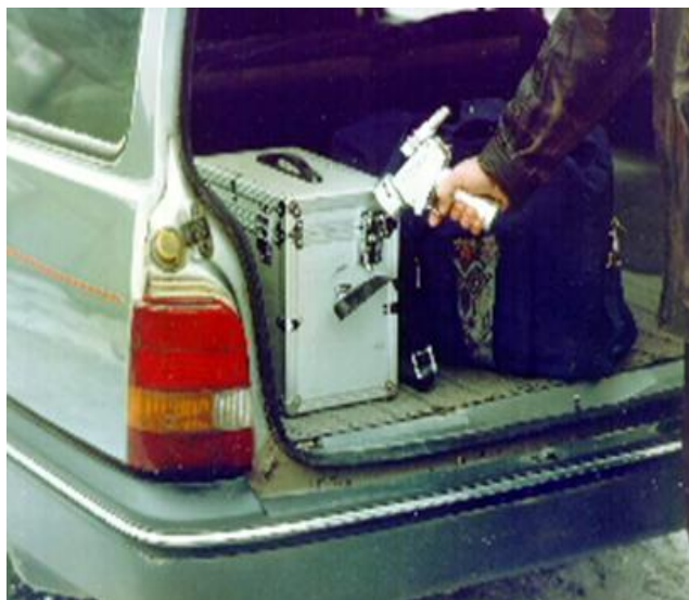
Рис. 2 – Установка вихревого пробоотборника на автотранспорт
