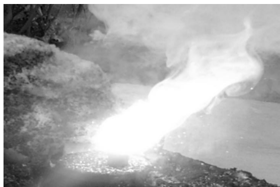
Рис. 5 – Горение пиротехнической системы 10Al+6KNO 3 с 8 масс. % флюорита
