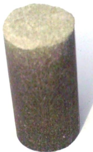
Рис. 2 – Прессованный образец системы 10\text{Al} + 6\text{KNO}_3 с добавкой 8 масс. % \text{CaF}_2
