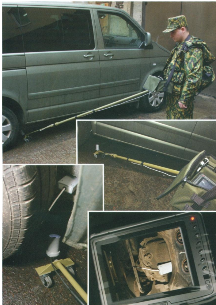
Рис. 2 – Использование устройства «Хобот-ДИ», предназначенного для дистанционного обнаружения и исследования минно-взрывных устройств, при осмотре днища автомобиля
