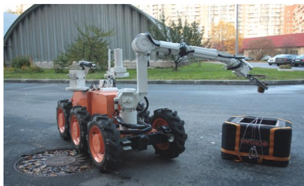
б – перемещение обнаруженного взрывного устройства внутрь взрывозащитного устройства;
