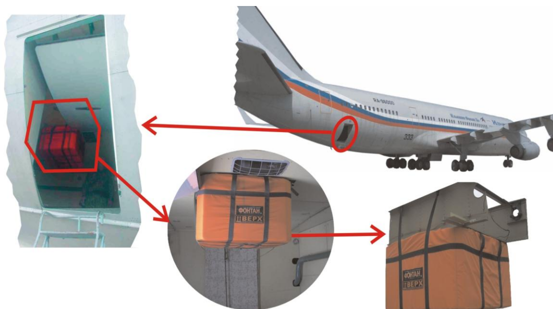
Рис. 7 – Размещение специализированного устройства защиты от взрыва «Фонтан 3МК-2000» на борту дальнемагистрального авиалайнера «Ил-96-300»
