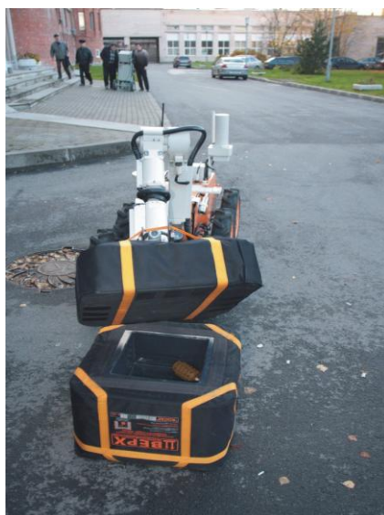
в – дистанционно управляемое закрытие взрывозащитного контейнера
