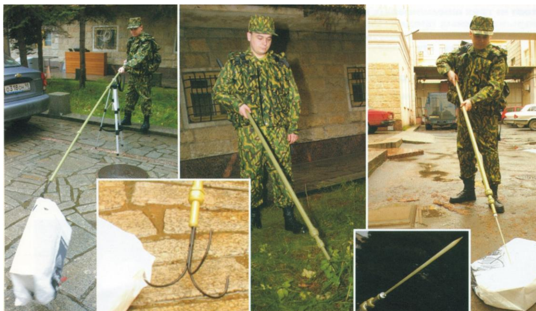
Рис. 3 – Работа с устройством «Хобот-ДВ», предназначенным для дистанционного воздействия на взрывоопасные предметы
