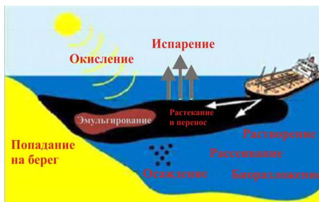
Рис. 1 – Поведение нефти при разливе в условиях чистой воды
