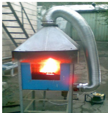
а – схема установки: 1 – емкость с водой; 2 – ограничительная рамка для нефти; 3 – вытяжной зонг; 4 – трубопровод; 5 – сажесборник; 6 – вытяжной вентилятор; б – фото установки
