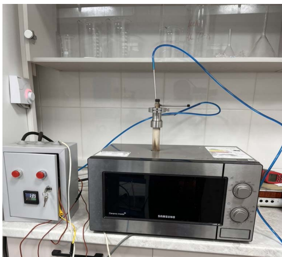
Рис. 1. Экспериментальная установка для микроволнового синтеза активированного угля из биомассы листового чая.
