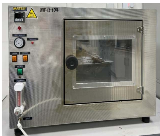
Рис. 1. Печь для проведения старения битумов (RTFOT).
