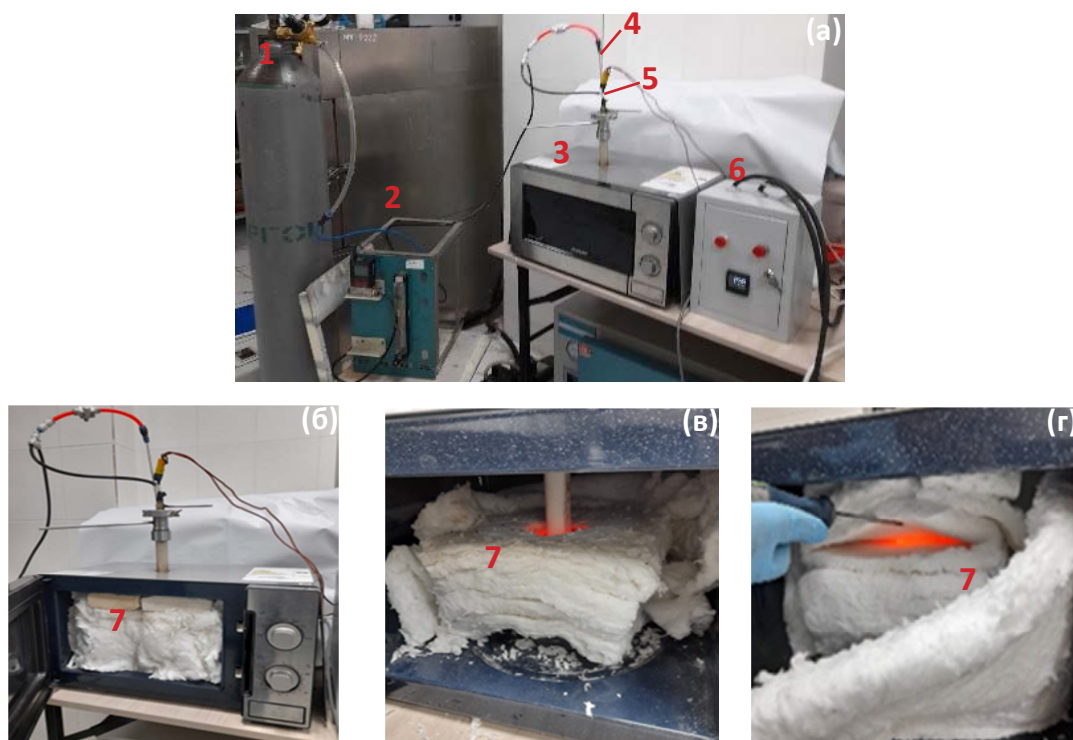
Рис. 1. Фотография общего вида установки для высокотемпературной обработки углеродных образцов: (а) – общий вид установки: 1 – баллон с инертным газом; 2 – регулятор расхода газа; 3 – микроволновая печь; 4 – термопара; 5 – керамический реактор; 6 – терморегулятор; 7 – теплоизоляция; (б, в, г) – внутренний вид микроволновой печи в процессе эксперимента.
