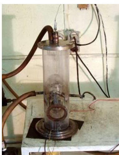
Рис. 3. Схема горелки и параметры эксперимента для синтеза сажи при низком давлении: 1 – кварцевый реактор; 2 – горелка; 3 – электрод для поджога; 4 – электрод для наложения электрического поля.
