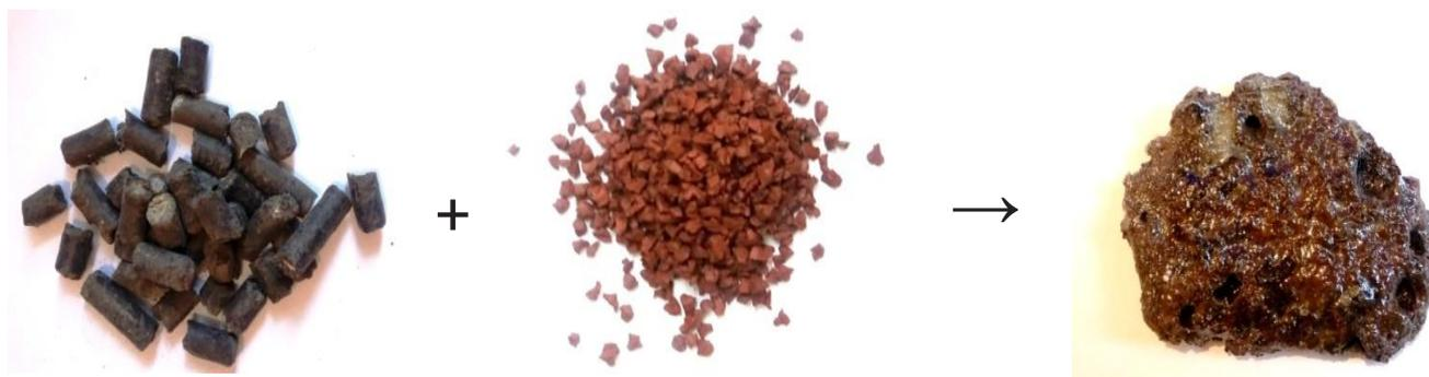
Рис. 3. Расплав шлака (справа), образовавшийся в результате пароплазменной газификации ДИ (слева) в 50%-й масс. смеси с РКИШ (посередине).
