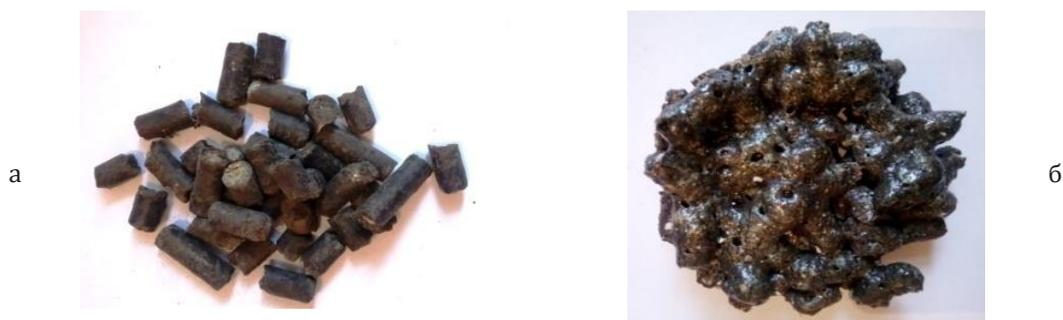
Рис. 2. Образцы гранул донного ила станции водоочистки г. Ивано-Франковска до переработки (а) и после их газификации и оплавления (б).
