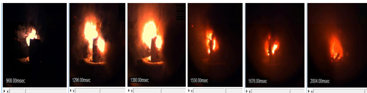
(AN/MgAl, 3МПа, время горения – 824мсек, h = 8,58мм)
