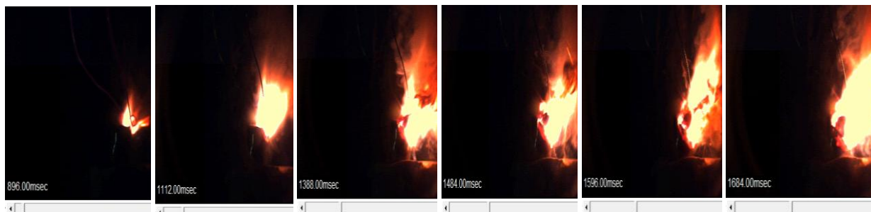
(AN + MgAl + Cr_2O_3 , 1МПа, время горения – 788мсек, h = 7,29мм)
