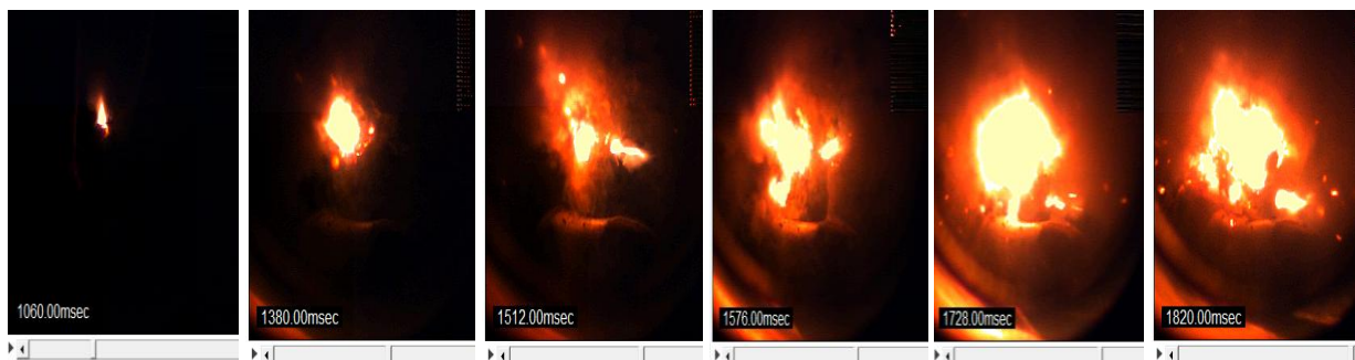
(AN/MgAl, 5МПа, время горения – 664мсек, h = 9,86мм)
