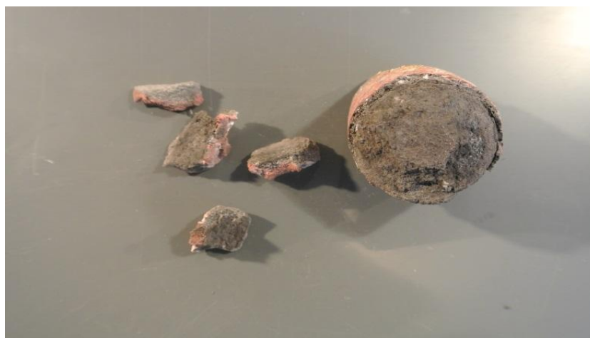
Рис. 3 – Внешний вид образца после СВС в высокотемпературной центрифуге
