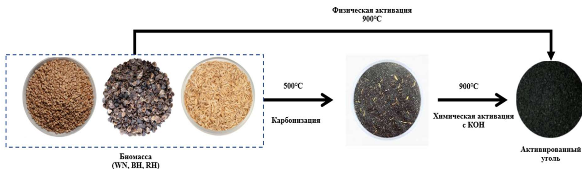
Рис. 1. Схема получения активированного угля путем физической и химической активации.
