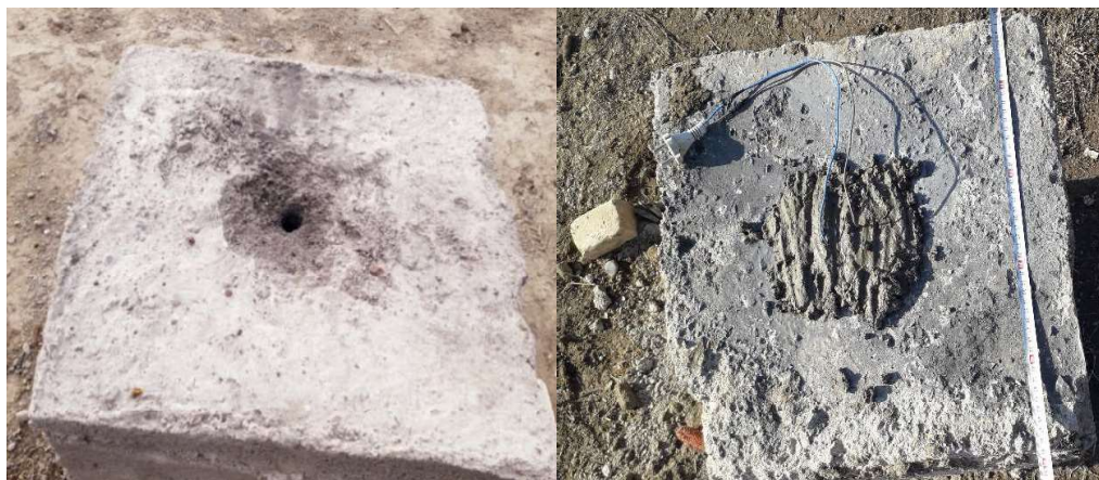
Рис. 6. Монолитный бетонный блок с зарядом состава №1.
