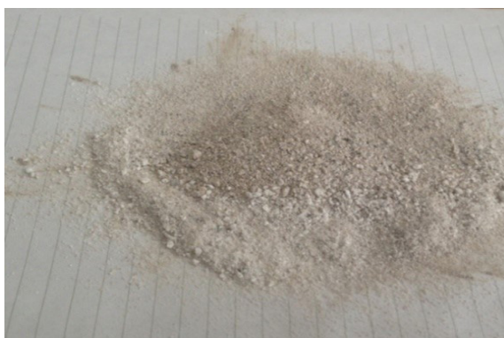
Рис. 2. Сжигание отходов кремнийорганических полимерных соединений (а), полученный супергидрофобный порошок (б).
