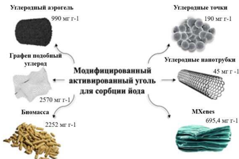
Рис. 1. Максимальная сорбционная емкость радиоактивного йода углеродными материалами.
