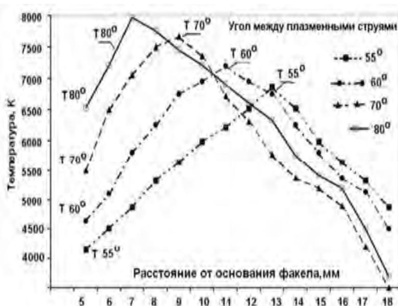
Рис. 3. Распределения температуры по оси плазменного факела ДДП при разных углах между плазменными струями.
