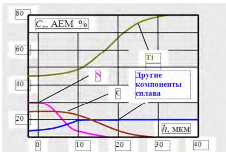
Рис. 5. Компонентный состав слоя, синтезированного на внутренней поверхности трубы из титанового сплава BT1-00 в ЭПП смеси азота и метана.
