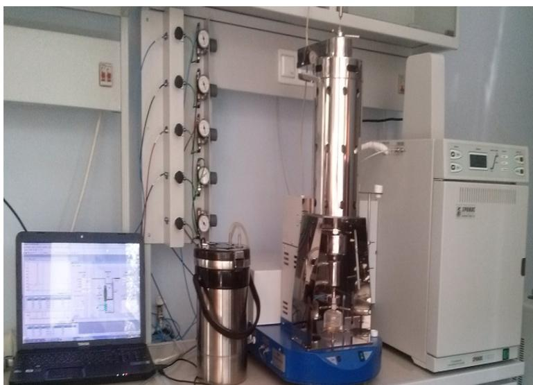
Рис. 1. Автоматизированная проточная каталитическая установка.
