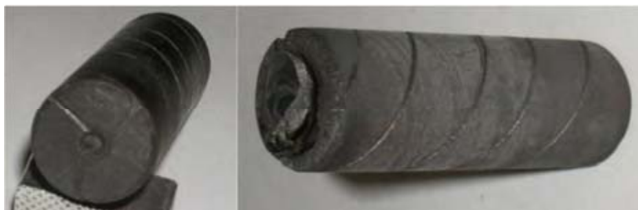
Рис. 2 – Фотографии графитовой вставки катода плазмотрона до начала работы (слева) и с кратером депозита на торце электрода после окончания работы (справа)
