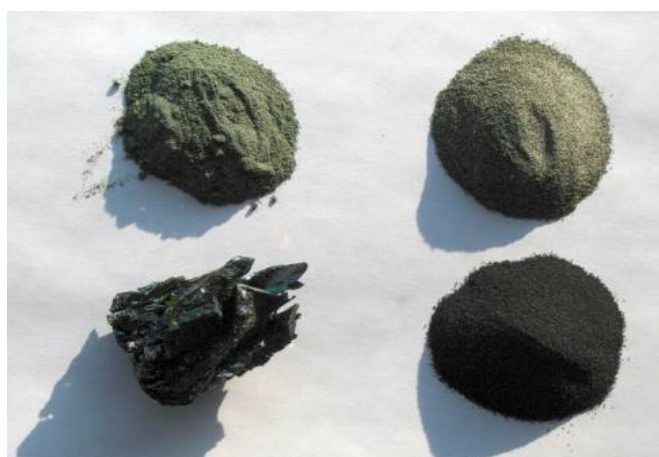
Рис. 4 – Образцы карбида кремния и шихты
