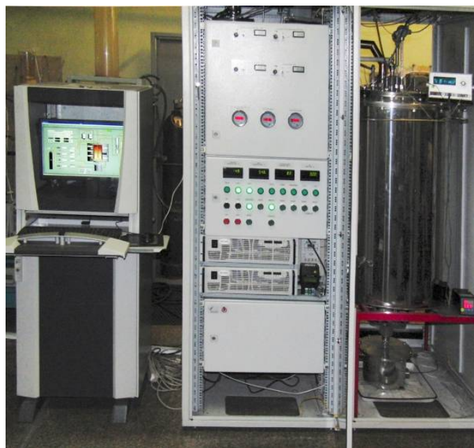
Рис. 1 – Экспериментальная установка с реактором ЭТКС (внутренний диаметр реактора 180 мм, напряжение на электродах ДС 0-200 В, электрический ток до 150 А)
