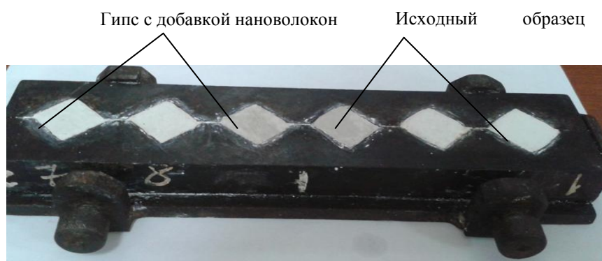
Рис. 2 – Фото приготовленных опытных образцов для твердения гипса
