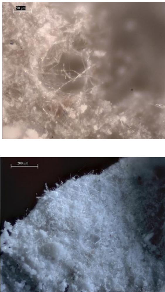
Рис. 3 – Изображения волокон в гипсе полученных методом импульсного электроспиннинга с помощью оптического микроскопа
