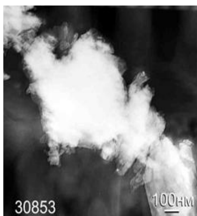
Рис. 6 – Изображения гипса с добавлением волокон (гипс + 0,6% волокна из ПММА) полученных с помощью просвечивающего электронного микроскопа.
