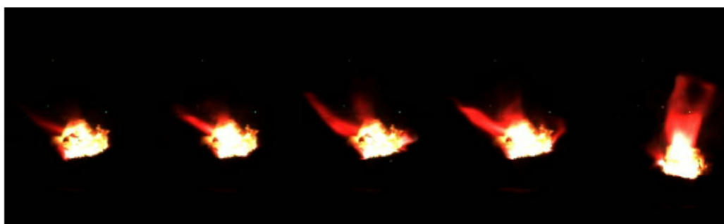
2 - \text{NH}_4\text{ClO}_4 + \text{Sr}(\text{NO}_3)_2 + \text{Mg} + \text{фенольная смола} , скорость горения - 2,36 мм/с
