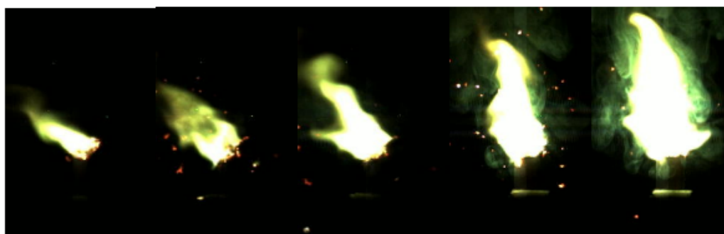
1 - \text{NH}_4\text{ClO}_4 + \text{Ba}(\text{NO}_3)_2 + \text{Mg} + \text{фенольная смола} , скорость горения - 2,53 мм/с
