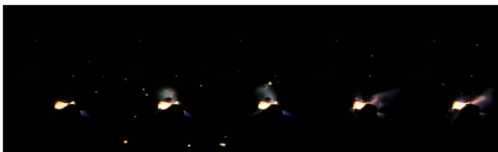
3 - \text{NH}_4\text{ClO}_4 + \text{Cu}(\text{NO}_3)_2 + \text{Mg} + \text{фенольная смола} , скорость горения - 2,18 мм/с
