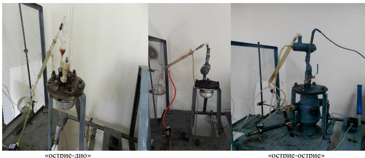
Рис. 1. Лабораторный реактор с различным расположением электродов
