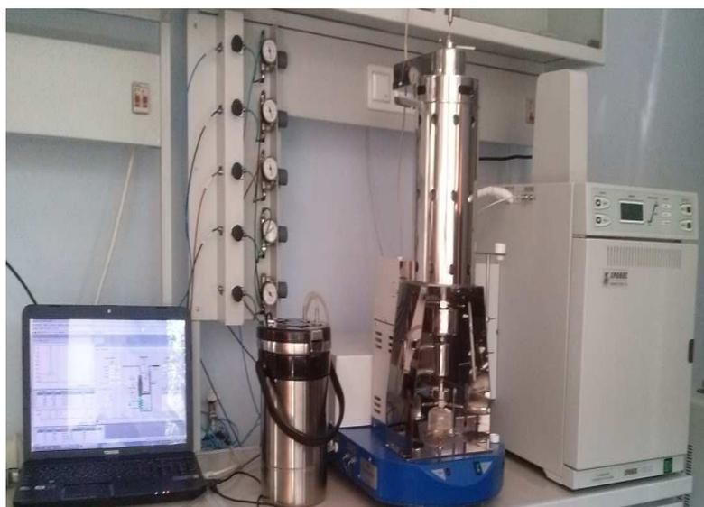
Рис. 1. Автоматизированная проточная каталитическая установка
