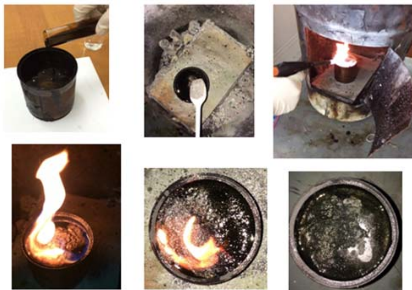
Рис. 4 – Методология использования и активация составов в качестве сорбента для ликвидации нефти в лабораторных условиях
