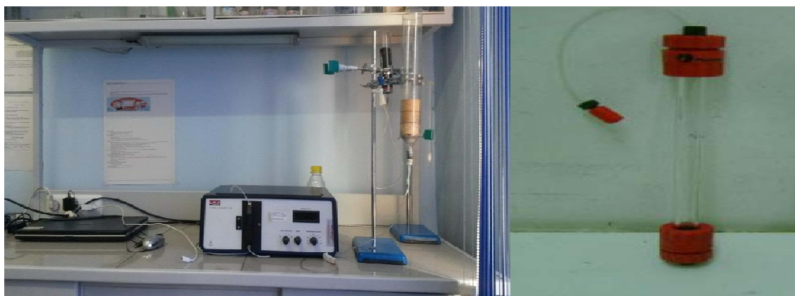
Рис. 9 – Колонки, наполненные углеродно-керамическими сорбентами
