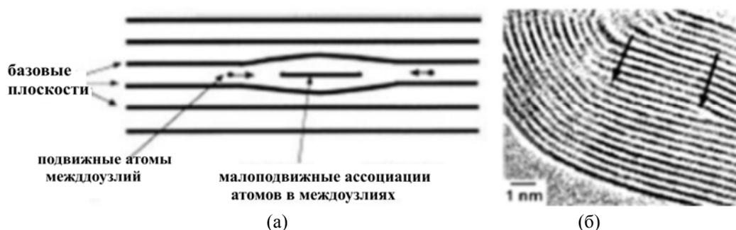
Рис. 1 – Схематическое изображение подвижных междуузлий – а, ВРЭМ микрофотография дислокационных петель в пространстве между графеновыми плоскостями. Стрелками указаны концы графеновой плоскости внедрения [21]
