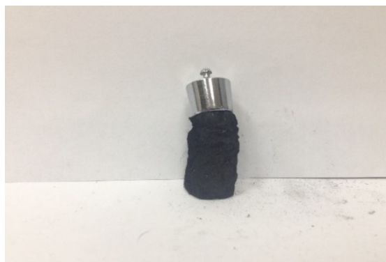
Рис. 7 – Фотография композитного аэрогеля на основе восстановленного MECVD графена, МУНТ и хитозана с нагрузкой 10 г
