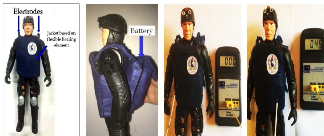
Рис. 5 – Фотографии макета и динамика изменения температуры жилета до подключения и после подключения жилета к источнику питания
