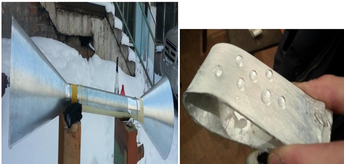
Рис. 4. Фотографии экспериментальной установки и капель воды на антиобледенительном покрытии
