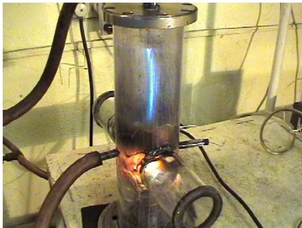
Рис. 1 – Внешний вид горелки и процесс горения при наложении разряда
