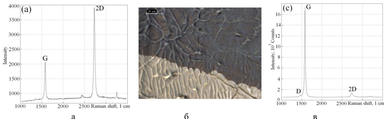
Рис. 5 – Раман-спектры однослойного графена (а), графитизированной структуры (в) и оптическая фотография структур на никелевой подложке (б), синтезированных в пламени  $C_6H_6/O_2$  на никелевой подложке с наложением отрицательного электрического потенциала  $U = -2$  В при  $P = 45$  Торр,  $C/O = 0,8$ ,  $T = 900$  °С,  $t = 2$  мин, (а:  $I_G/I_{2D} = 0,53$ ,  $I_D/I_G \approx 0$ ; б:  $I_G/I_{2D} = 12,66$ ,  $I_D/I_G = 0,04$ )
